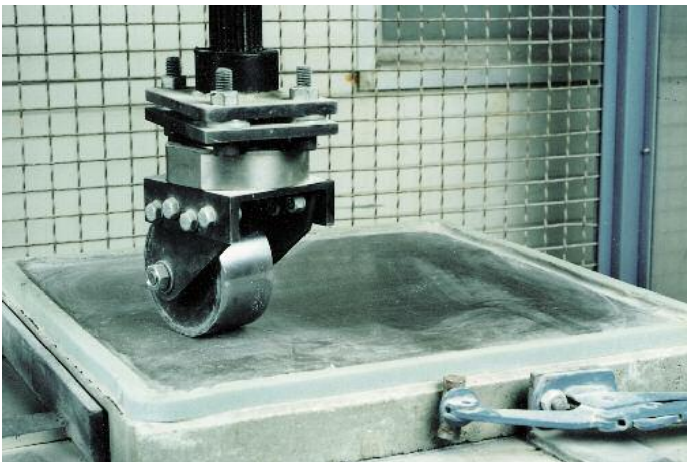
Avnötning med rullande hjul, SP66. Källa Statens Provnings- och Forskningsinstitut Avnötning, mm
